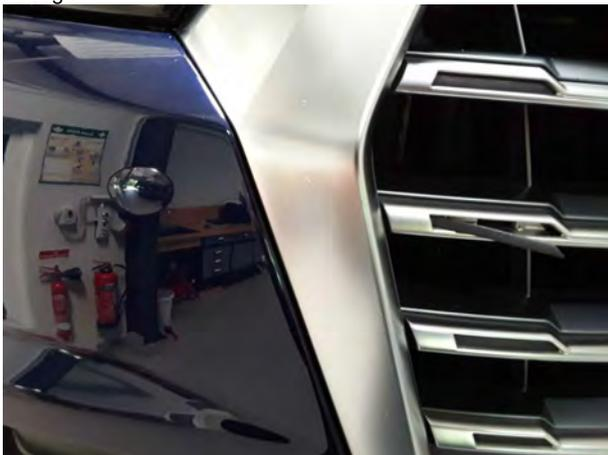
Beschädigung #1: Motorhaube: Kühlergrill - Steinschlag - kein Abzug
